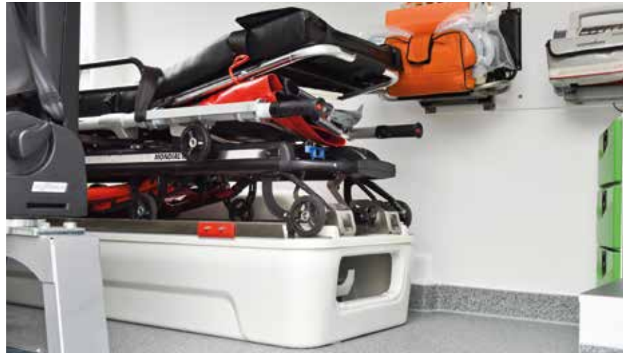
Die neue Tragenlagerung trägt maßgeblich zur Gewichtseinsparung bei.
