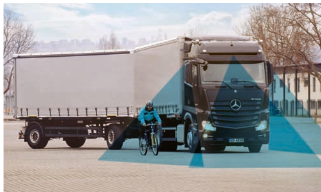
Kann den Fahrer bei Ab- und Einbiege-Manövern, beim Rückwärtsfahren und beim Rangieren unterstützen und die Sicherheit erhöhen.
