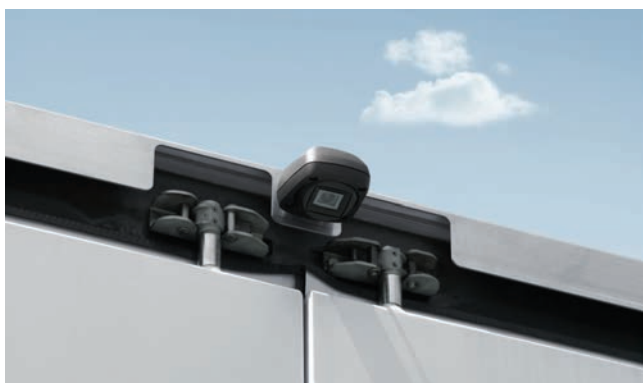
Die Rückfahrkamera kann variabel am Fahrzeugheck, bspw. auf dem Aufbau platziert werden und überwacht den Bereich hinter dem Fahrzeug.
