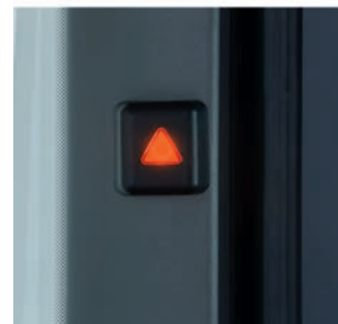
Lenkt den Blick des Fahrers auf die Gefahrenzone: gelb oder rot aufleuchtende Warnlampe in der A-Säule.
